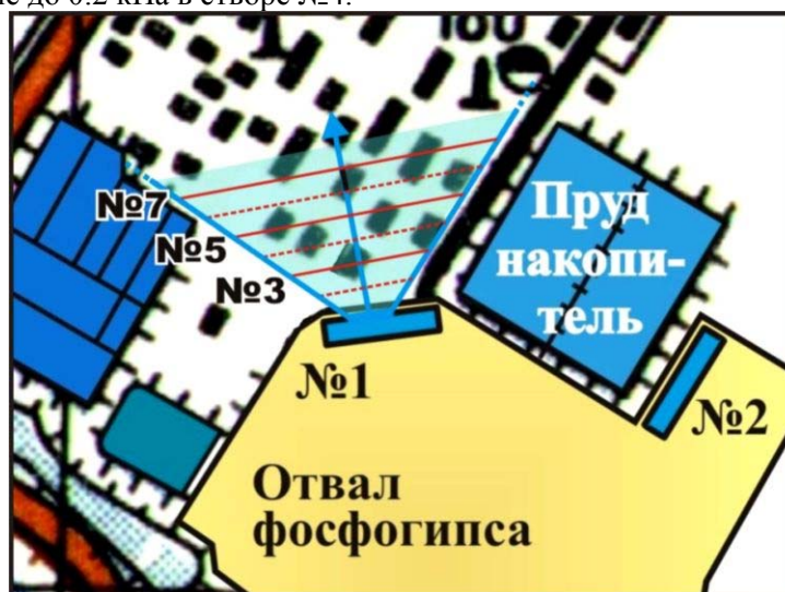
Рис.7. Зона затопления при аварийном разрушении дамбы водосборной системы отвального хозяйства
