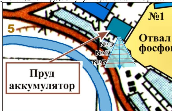
Рис.6. Зона затопления при аварийном разрушении дамбы пруда-аккумулятора
